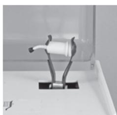
Plaats de GCP CAPSULE in een mixer (of een amalgamator), sluit het deksel en mix onmiddellijk gedurende 10-15 seconden (ongeveer 4300 trillingen/min).
