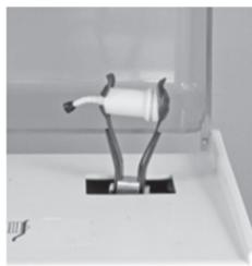
Geben Sie die GCP CAPSULE in einen Mischer (oder einen Amalgamator), schließen Sie den Deckel und mischen Sie unmittelbar für 10-15 Sekunden (ungefähr 4.300 Schwingungen/Min.).
