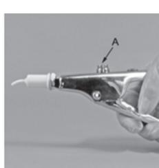
Fügen Sie die GCP CAPSULE in die Kapselpistole ein. Ziehen Sie den Hebel 2 Mal (2 Klicks), um die GCP CAPSULE vorzuspannen. Extrudieren Sie den Inhalt direkt in die vorbereitete Oberfläche. Entriegeln Sie die Pistole und entfernen die Kapsel.
