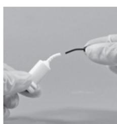
Entfernen Sie nach dem Mischen den Stift von der Düse.
