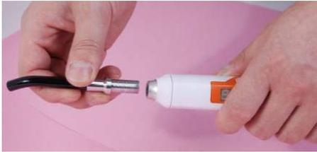
Insérez soigneusement la fibre optique dans la pièce à main, en vous assurant qu'elle soit complètement insérée. Une fois installée elle peut être tournée en toute sécurité.
