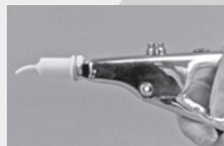
Retirer le bouchon de la capsule et injecter directement à l'aide du pistolet.
