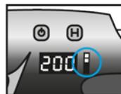
Un voyant rouge clignotant indique un faible niveau de charge de la batterie, une charge complète de la batterie est alors recommandée. Une fois l'appareil Beta totalement rechargé, il peut être utilisé de manière continue pendant environ 90 minutes.
