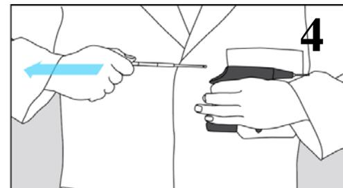
Retirer le piston dans l'axe du pistolet. Nettoyer la chambre à l'aide des brossettes de nettoyage tant que le pistolet est sous tension (Cf. instructions point 3 ci-dessous).
