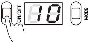
Une fois la lampe LEDEX™ WL-070+ mise sous tension, presser à nouveau le bouton ON/OFF pour actionner la lampe. Un compte à rebours s'affichera à l'écran.
