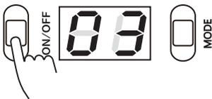
Durant le temps d'exposition, il est possible d'interrompre le cycle par simple pression du bouton ON/OFF. Le système émettra alors un bip et réinitialisera automatiquement le temps d'exposition.
